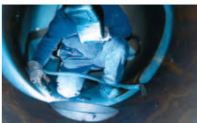
El proceso de soldadura por MIG pulsado es ideal para unir componentes con espesores de pared finos a medios. Incluso a altas velocidades de soldadura se consiguen también buenas profundidades de penetración y la unión de los flancos.
