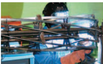
En la soldadura normal MIG se genera un arco uniforme que resulta especialmente útil para unir aceros de bajo espesor. La construcción de vehículos, la industria eléctrica, los sistemas de calefacción, los electrodomésticos y la industria de muebles son aquí los sectores clásicos. Además, el Short Arc se utiliza sobre todo para la soldadura de reparación segura en todos los ámbitos de la industria y permite soldar con CO<sub>2</sub> puro.
